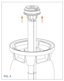
Ziehen Sie Ventil und Saugrohr oder Ventil und Beutel-Kit aus der Flasche.
