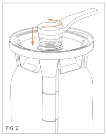
Schrauben Sie das Ventil mit dem entsprechenden Demontageschlüssel
