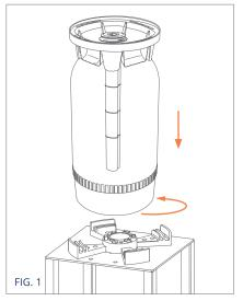
Schrauben Sie das drucklose Fass auf den Geräteboden.
