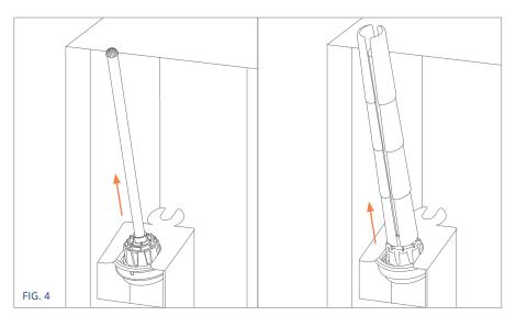
Stecken Sie das Ventil in die große Öffnung und trennen Sie den Schlauch oder das Beutel-Kit vom Ventil.
