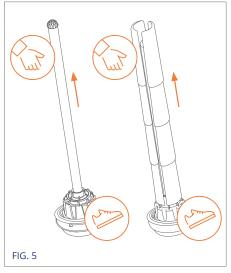
Trennen Sie das Ventil vom Saugrohr oder Beutel-Kit, indem Sie das Ventilteil festhalten und das Saugrohr oder Beutel-Kit zu sich ziehen.
