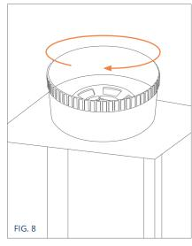
Schrauben Sie den Fassboden vom Gerät ab.
