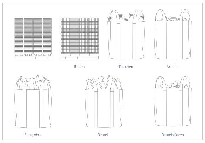
Lagern Sie die Teile in den entsprechenden Behältern.
