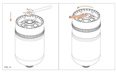
Befestigen Sie den Demontageschlüssel am Boden des Fasses und drehen Sie den Hebel um 180° gegen den Uhrzeigersinn.
